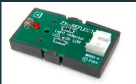
แผงวงจรตรวจจับการสะท้อน
