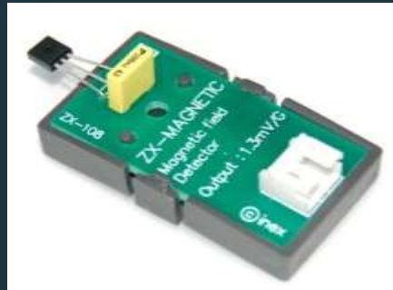
แผงวงจรตรวจจับสนามแม่เหล็ก
