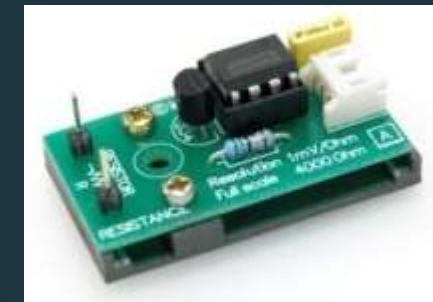
แผงวงจรตรวจวัดค่าความต้านทาน
