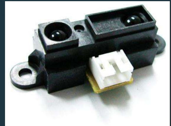
โมดูลตรวจจับและวัดระยะทางด้วย แสงอินฟราเรด
