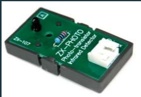
แผงวงจรตรวจจับแสง อินฟราเรด
