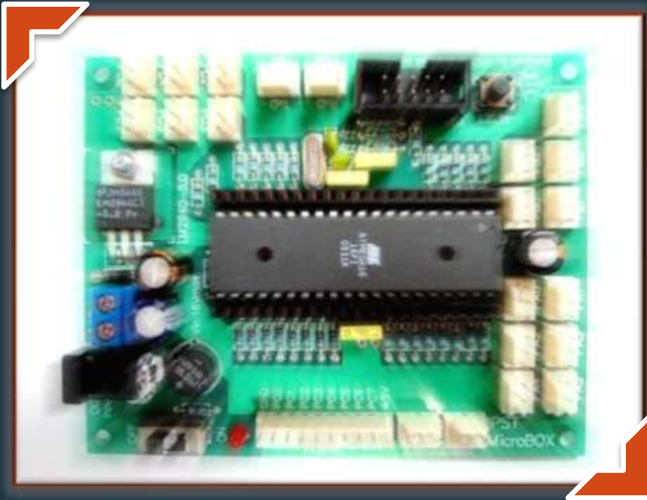
แผงวงจร IPST-MicroBOX
