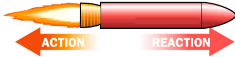
รูปที่ 6.3 แสดงหลักการขับเคลื่อนให้จรวดสามารถเคลื่อนที่ไปข้างหน้าได้
