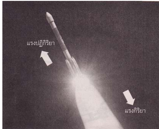
รูป 5.12 แสดงการเกิดแรงกิริยาและแรงปฏิกิริยา
